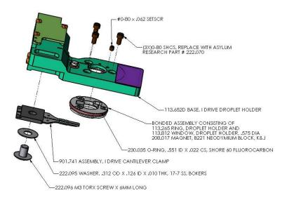
Figure 7.1.: iDrive Droplet Holder
