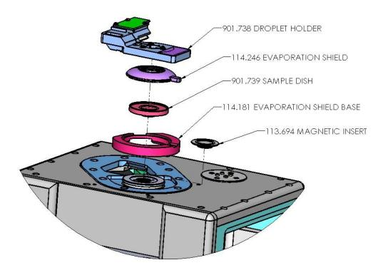
Figure 6.1.: Droplet Cantilever Holder nomenclature.
